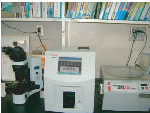
カラム凝固法による輸血自動検査機器 (オーソバイオビュー)
